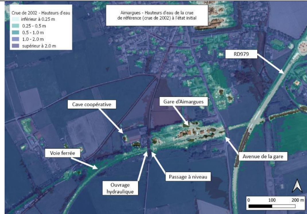
FIGURE 46 : HAUTEURS D’EAU AU DROIT DE LA VOIE FERREE AU SUD D’AIMARGUES POUR LA CRUE DE REFERENCE A L’ETAT INITIAL
