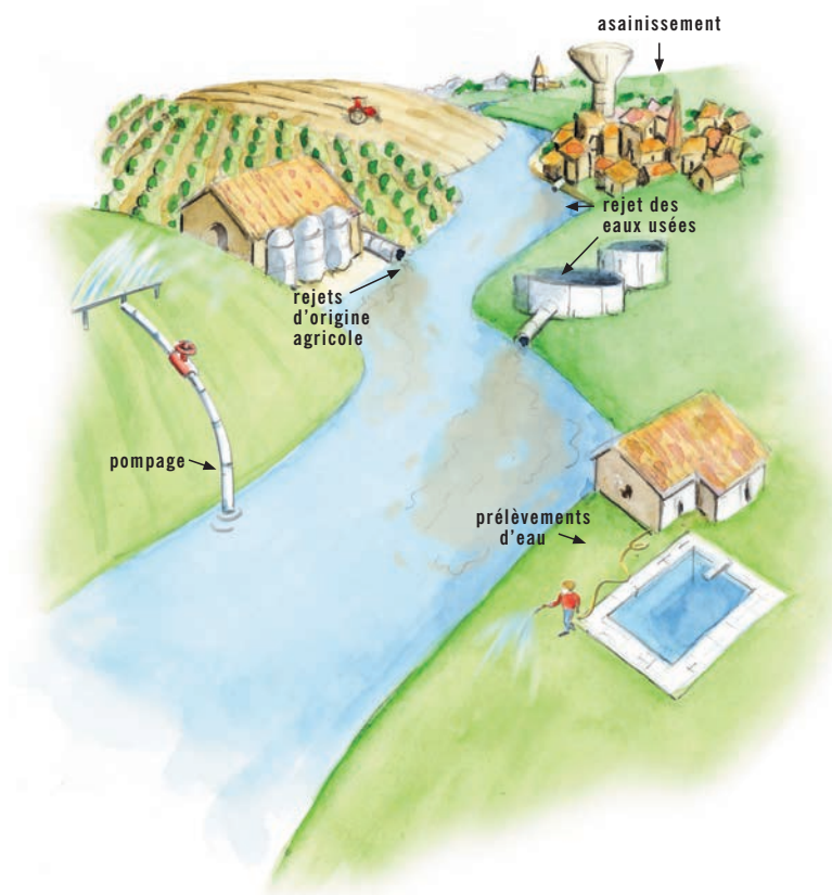
Les sources de dégradation de la qualité de l'eau
